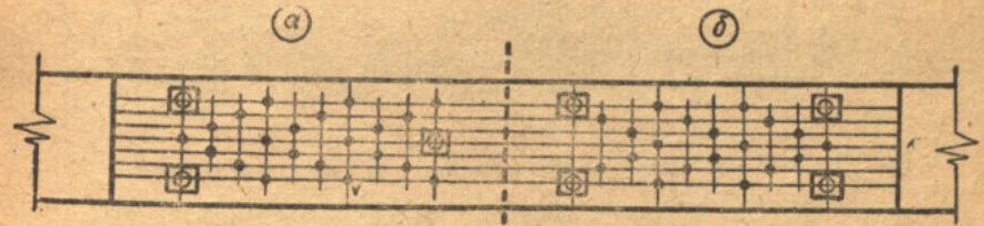
Рис. 3. Стыки на гвоздях и круглых нагелях.
