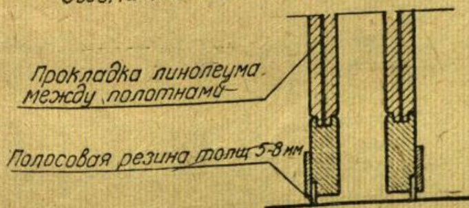
Схема нижней части дверн. полотен
